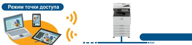
*Примечание:* Доступ к внешним сетям через МФУ невозможен. Одновременно к МФУ может быть подключено до пяти мобильных устройств.
