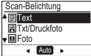
Ändern Sie zum Auswählen die Stufe (5 Stufen sind verfügbar) mit den Tasten [◀] [▶].
