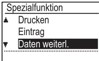
**Weiterleitung empfangener Faxe** Wählen Sie "Daten weiterl." mit der Taste [▼] oder [▲] und drücken Sie die Taste [OK].
