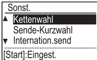
**Wählen Sie "Kettenwahl" mit der Taste [▼] oder [▲] und drücken Sie die Taste [OK].**
