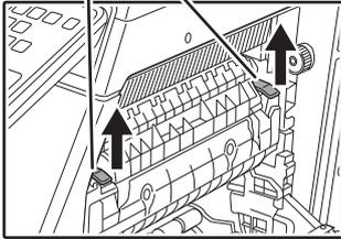
**Heben Sie die Einstellhebel der Fixiereinheit an, damit das Papier leichter entfernt werden kann.**
