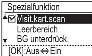
Drücken Sie die Taste [SPEZIALFUNKTION] (Fn), und danach die Taste [▼] oder [▲] zum Auswählen von "Visit.kart.scan".
