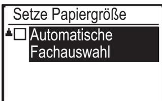
Um die automatische Fachauswahl wieder zu aktivieren, drücken die Taste [OK], so dass das Häkchen angezeigt wird.
