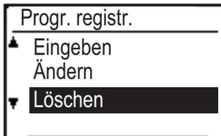
Wählen Sie "Löschen" mit den Tasten [▼] [▲] und drücken Sie die Taste [OK].
