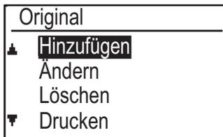
(1) **Möchten Sie das neue Dokument hinzufügen, wählen Sie "Hinzufügen" mit der Taste [▼] oder [▲], drücken Sie die Taste [OK] und gehen Sie dann zu Schritt 2.**
